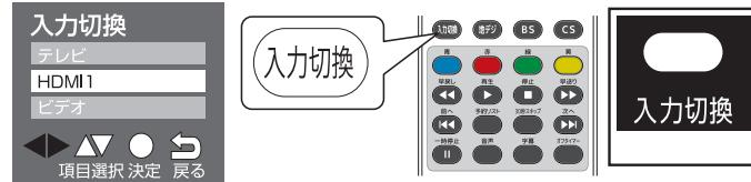
※本体の【機能切換】ボタンで操作した場合、地デジ → BS → CS → HDMI → ビデオの順に切り換わります
