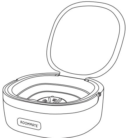
②ふたを開け、片手で本体の底面を押さえながら、もう一方の手で外枠を上に引き上げます。
