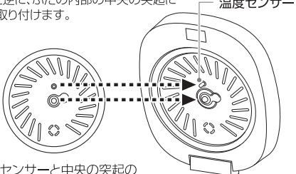
温度センサーと中央の突起の位置を合わせて押し込みます。
