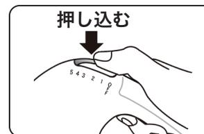
スピード切替スイッチをOFFの位置にし、図のように上から強く押し込めば外れます。
