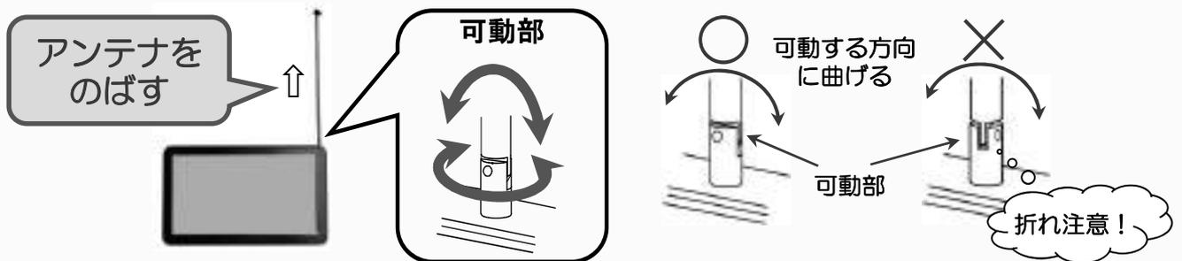
※アンテナの回転方向を確認の上、向きをかえてください。
