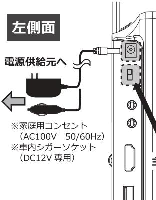
付属品の電源アダプター（A Cアダプターまたは車載用D Cアダプター）と本体を接続し、コンセント側またはD C 1 2 Vシガーソケットと接続します。電源アダプター接続後、本体に正しく通電されると、充電ランプ（赤）が点灯して充電が始まります。（充電中：点灯／満充電時：消灯）通電中または充電池に蓄電された状態で主電源を入れると、電源ランプ（緑）が点灯して本体が起動します。
