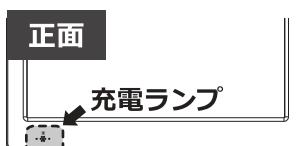
本体電源入力端子に電源アダプターを接続しコンセント側を差して本体に通電されると内蔵充電池に充電されます。充電中は本体正面の充電ランプ（赤）が点灯します。
