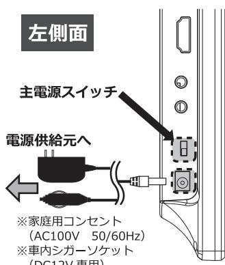
付属品の電源アダプター（ACアダプターまたは車載用DCアダプター）と本体を接続し、コンセント側またはDC12Vシガーソケットと接続します。電源アダプター接続後、本体に正しく通電されると、充電ランプ（赤）が点灯して充電が始まります。（充電中：点灯／満充電時：消灯）通電中または充電池に蓄電された状態で主電源を入れると、電源ランプ（緑）が点灯して本体が起動します。
