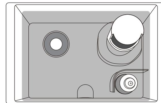
水を入れたタンクを貯水槽にセットすると、排水弁が開放され、貯水槽に水を供給します。貯水槽に水が溜まると、水位センサーの役割を果たすフロートが浮き、ミストが発生します。
