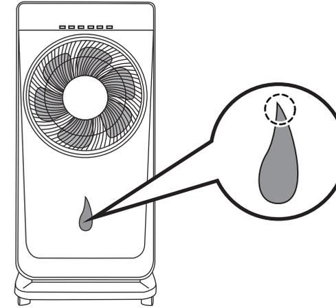
タンク及び貯水槽に水が入っていないときは、シズクマークの上部(豆ランプ)が、「赤く点灯」します。十分な水が入っているときは、「青く点灯」します。
