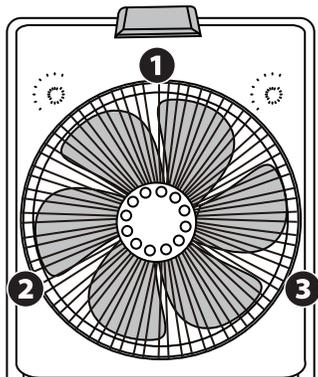
1. 本体背面に取り付けられた3箇所のネジをドライバーで外す。
