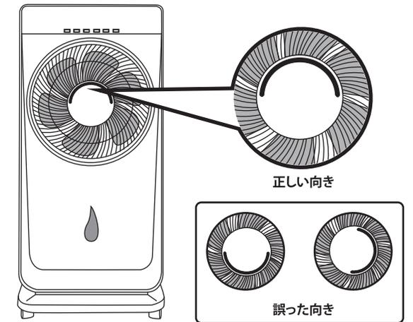
誤った向きで使用すると、水滴が床に落ち、床濡れの原因になります。噴出口を回転させて正しい向きに直してください。
