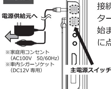
付属品の電源アダプター (A Cアダプターまたは車載用D Cアダプター) と本体を接続し、コンセント側またはD C 1 2 Vシガーソケットと接続します。電源アダプターを接続して正しく本体に通電がされると、充電ランプが赤色に点灯して充電が始まります (満充電: 緑点灯)。通電確認後、主電源を入れると電源ランプが緑色に点灯して本体が起動します。
