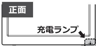
本体電源入力端子に電源アダプターを接続しコンセント側を差して本体に通電されると内蔵充電電池に充電されます。充電中は本体正面の充電ランプが赤く点灯します。
