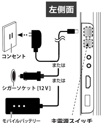
本体と付属品のUSB-CケーブルおよびACアダプタまたはカーアダプタを接続して、コンセントまたはシガーソケットに接続します。さらに、USB-Cケーブルとモバイルバッテリー(市販品、5V=2A以上)を接続して使用できます。
