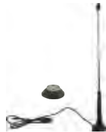
アンテナ、アンテナ台座 アンテナ画像は伸ばした状態です 台座を着けることで電波を若干、 増幅できます
