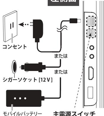
本体と付属品のUSB-CケーブルおよびACアダプタまたはカーアダプタを接続して、コンセントまたはシガーソケットに接続します。さらに、USB-Cケーブルとモバイルバッテリー(市販品、5V=2A以上)を接続して使用できます。
