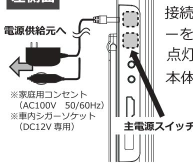
付属品の電源アダプター（ACアダプターまたは車載用DCアダプター）と本体を接続し、コンセント側またはDC12Vシガーソケットと接続します。電源アダプターを接続して正しく本体に通電されると、充電ランプが赤色に点灯します。（充電中：点灯／満充電時：消灯）通電確認後、主電源を入れると電源ランプが緑色に点灯し、本体が起動します。
