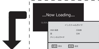
\*電源を入れるとシステム起動中(左図)の表示後、<インストールガイドの表示>または<チャンネル自動検索の開始>となります。(※機種により異なる)
