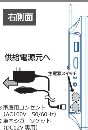
付属品の電源アダプター（ACアダプターまたは車載用DCアダプター）と本体を接続し、コンセント側またはDC12Vシガーソケットと接続します。電源アダプターを接続して正しく本体に通電されると、充電ランプが赤色に点灯します。（充電中：点灯／満充電時：消灯）通電確認後、主電源を入れると電源ランプが緑色に点灯し、本体が起動します。
