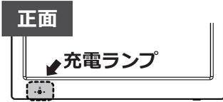
本体電源入力端子に電源アダプターを接続しコンセント側を差して本体に通電されると内蔵充電電池に充電されます。充電中は本体正面の充電ランプが赤く点灯します。
