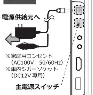
付属品の電源アダプター (AC アダプターまたは車載用 DC アダプター) と本体を接続し、コンセント側または DC12V シガーソケットと接続します。電源アダプターを接続して正しく本体に通電されると、電源表示 (充電) ランプが赤く点灯して充電を開始します。満充電になると緑色に点灯します。主電源を入れるとランプが緑色に点灯して本機が起動します。
