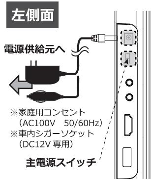
付属品の電源アダプター（ACアダプターまたは車載用DCアダプター）と本体を接続し、コンセント側またはDC12Vシガーソケットと接続します。
