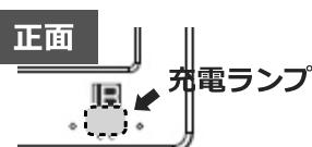
本体電源入力端子に電源アダプターを接続しコンセント側を差して本体に通電されると内蔵充電池に充電されます。充電中は本体正面の充電ランプが赤く点滅します。
