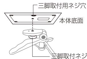
三脚取付用ネジ穴 本体底面 三脚取付ネジ
