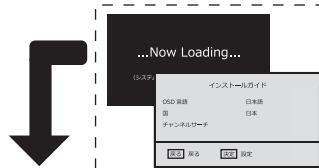
\* 電源を入れるとシステム起動中(左図)の表示後、＜インストールガイドの表示＞または＜チャンネル自動検索の開始＞となります。(※機種により異なる)
