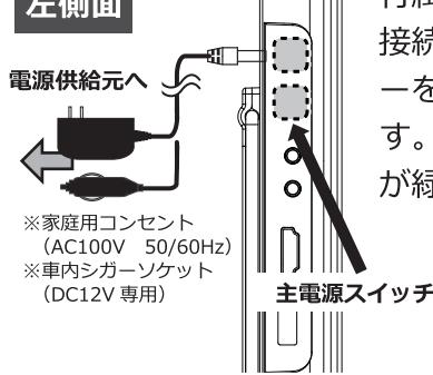
付属品の電源アダプター（ACアダプターまたは車載用DCアダプター）と本体を接続し、コンセント側またはDC12Vシガーソケットと接続します。電源アダプターを接続して正しく本体に通電されると、充電ランプが赤色に点滅または点灯します。（充電中：点滅／満充電時：点灯）通電確認後、主電源を入れると電源ランプが緑色に点灯し、本体が起動します。
