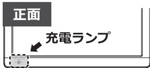
本体電源入力端子に電源アダプターを接続しコンセント側を差して本体に通電されると内蔵充電電池に充電されます。充電中は本体正面の充電ランプが赤く点滅します。
